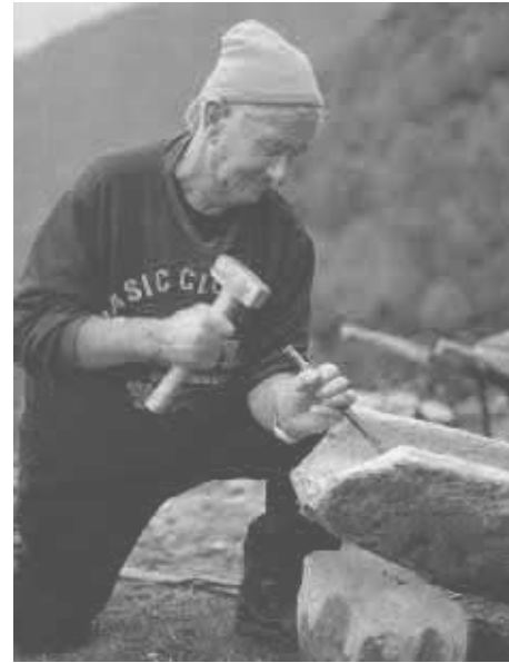
Lavorazione dei canali con punta e mazzotto.
